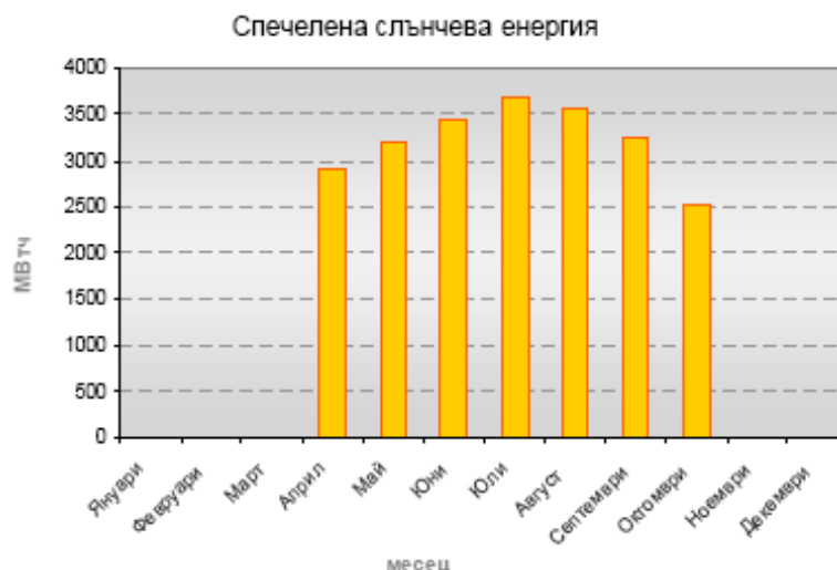
Фиг.2 Разпределение на възможната за оползотворяване слънчева енергия по месеци при сезонна работа на инсталациите
